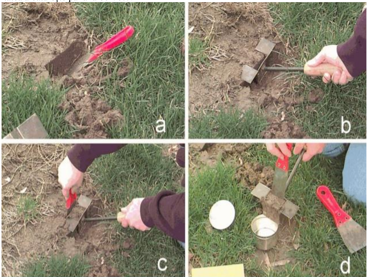
Fig. 2. Prelevarea probelor pentru evaluarea porozității solului
